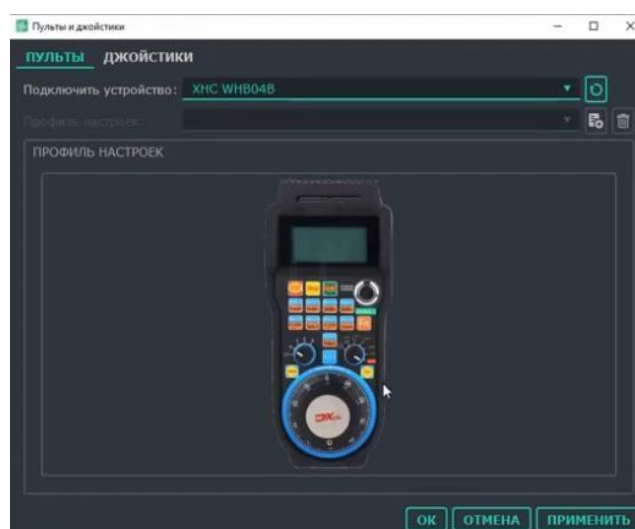
Рисунок 94. Подключение пульта WHB04B
